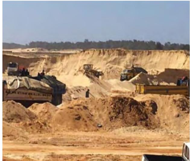
**Photo 35 : Extraction massive du sable marin**
