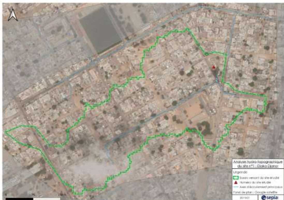
Exemple d'identification des axes d'écoulement et de délimitation du bassin versant (Djaka Djanor)
