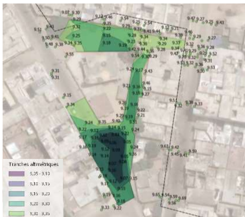
Exemple d'exploitation d'un relevé topographique : étude de l'inondabilité d'un site pour plusieurs cotes altimétriques
