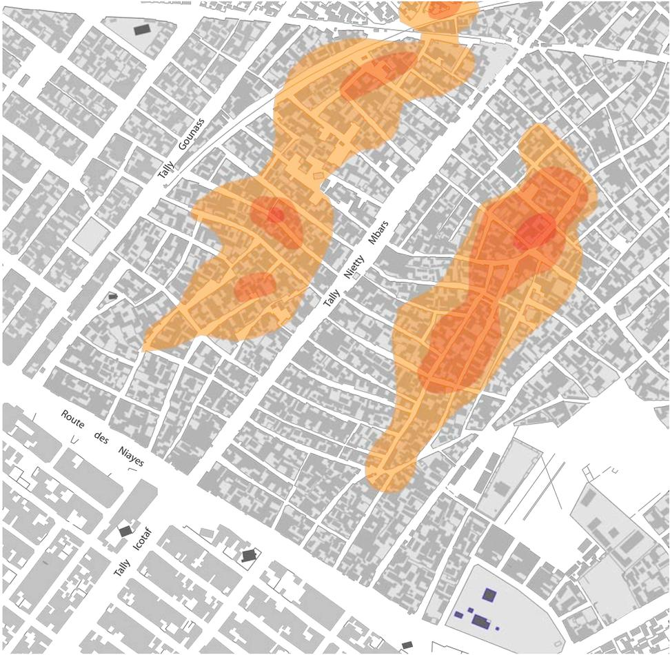
**Figure 7.** Simulation du risque de relèvement de la nappe sur la zone de Nietty Mbars et Mousdalifa. Projection 2012 : scénario déconnection des forages de Thiaroye. Zones Inondées. USF, 2009.
