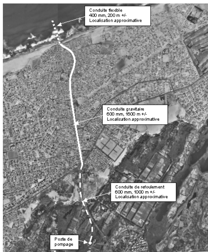
Localisation de la canalisation de refoulement de Cambérène, SNC-Lavalin International inc
