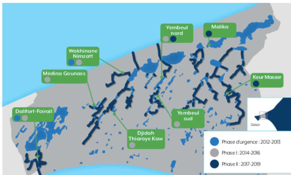
Figure 6. La localisation des ouvrages de drainage réalisés par le PROGEP 28 (ADM, 2019)
